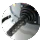
Vibrador filtro manual
