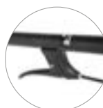
Palanca de activación de la tracción mecánica
